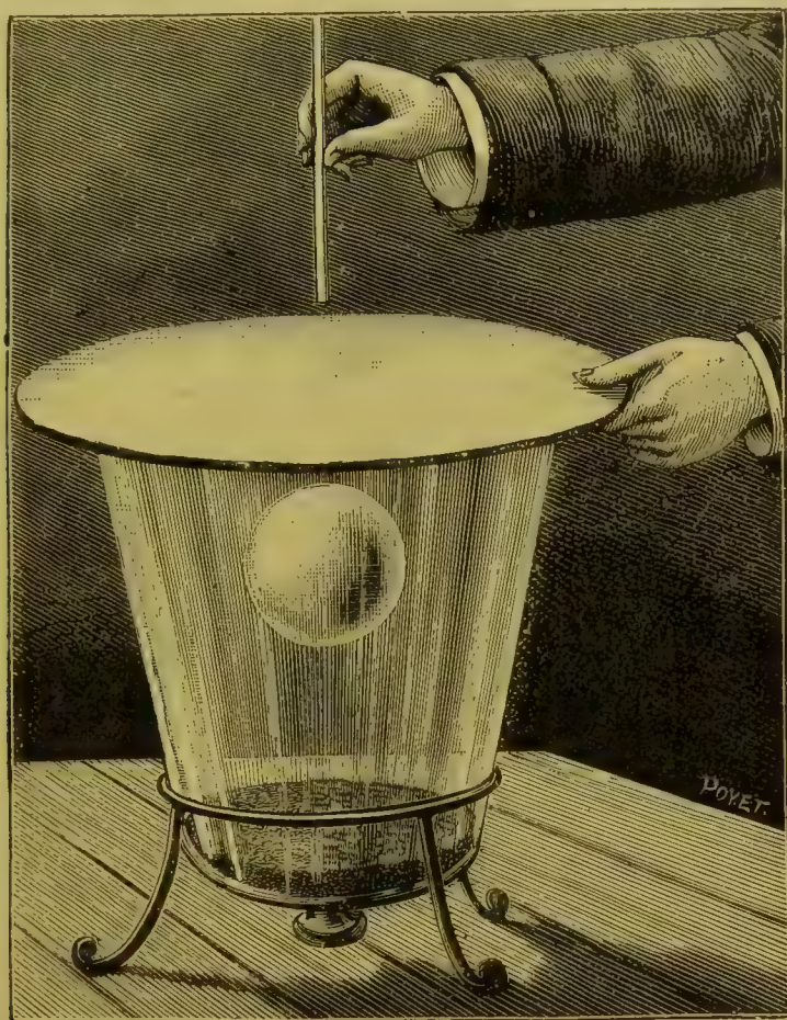
Fig. 199. Bolla di sapone gonfiata d'aria, fluttuante alla superficie del gas acido carbonico.
